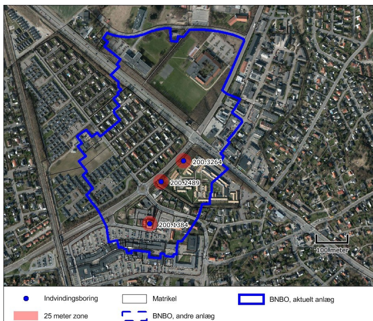
Figur 1 Placeringen af borerne ved Smedebakken vandværk. Boring 200.1384 benyttes ikke, grundet denne er stærkt forurenet.
